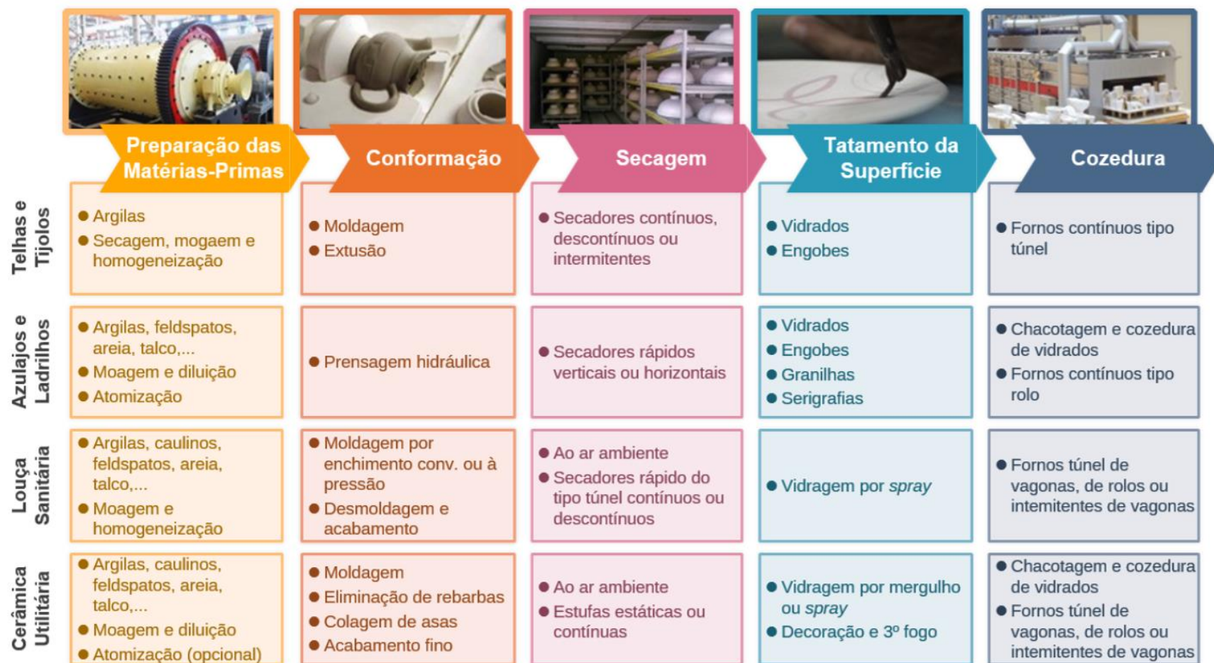
Figura 1: Principais etapas do processo de fabricação de produtos cerâmicos. Fonte: MEESI (2019).
